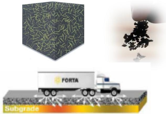
L'efficacia delle fibre di rinforzo FORTA FI si avvicina al comportamento meccanico delle macrofibre polimeriche nel calcestruzzo fibrorinforzato.
