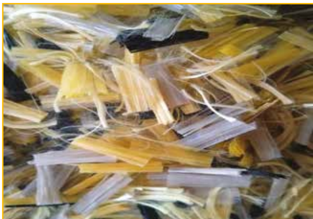
Fig. 1. Un CB contenente le fibre aramidiche e poliolefiniche
